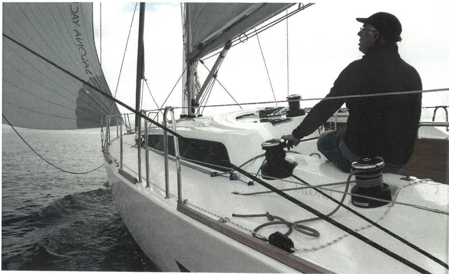
Klasičan raspored vinčeva u prednjem dijelu kokpita i na kabini
